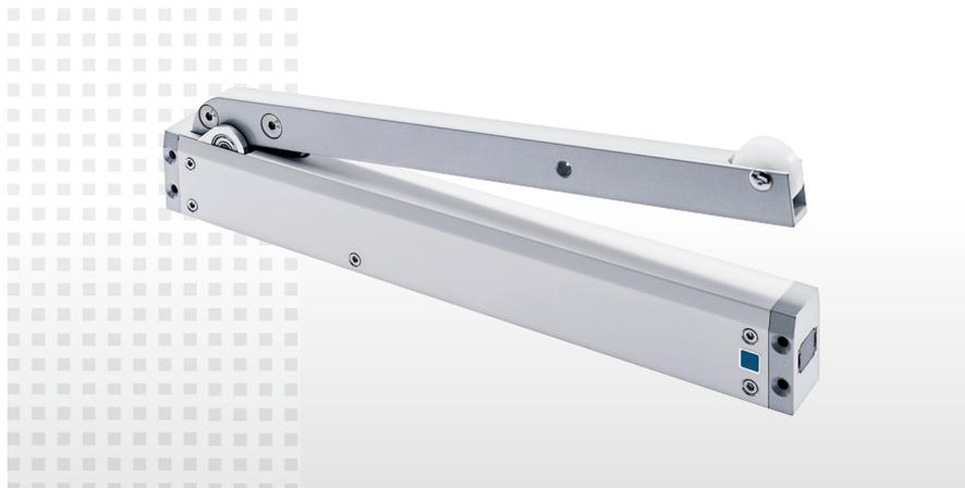
Рычажные приводы от компании AUMÜLLER имеют алюминиевый корпус изящной прямоугольной формы с расположенным сбоку рычагом. В закрытом состоянии рычаг прилегает к корпусу привода. Угол его открытия составляет ок. 93°. Наряду с классическим применением на окнах эти приводы также подходят для установки на дверях для подачи замещающего воздуха.
