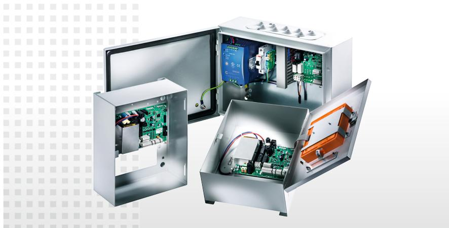
Компактные блоки управления для управления оконными электроприводами 24 В для открывания и закрывания окон в случае дымоудаления и контролируемой естественной вентиляции в небольших и средних по площади секциях зданий, например, на лестничных клетках.
