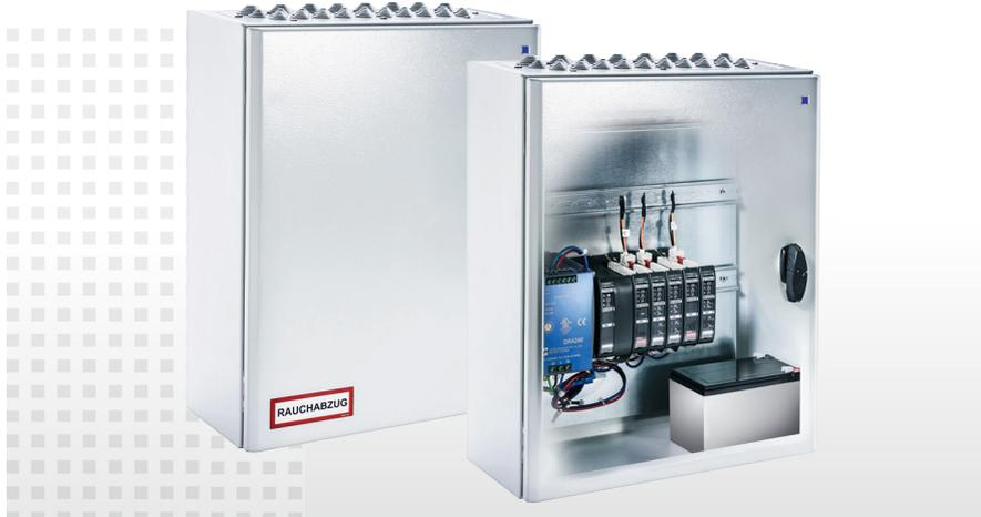
Модульный блок управления для систем дымо- и теплоудаления с технологией цифровой шины и обеспечением резервного электропитания для управления оконными электроприводами 24В для открывания и закрывания окон для дымоудаления и вентиляции в средних и больших по площади зданиях.
