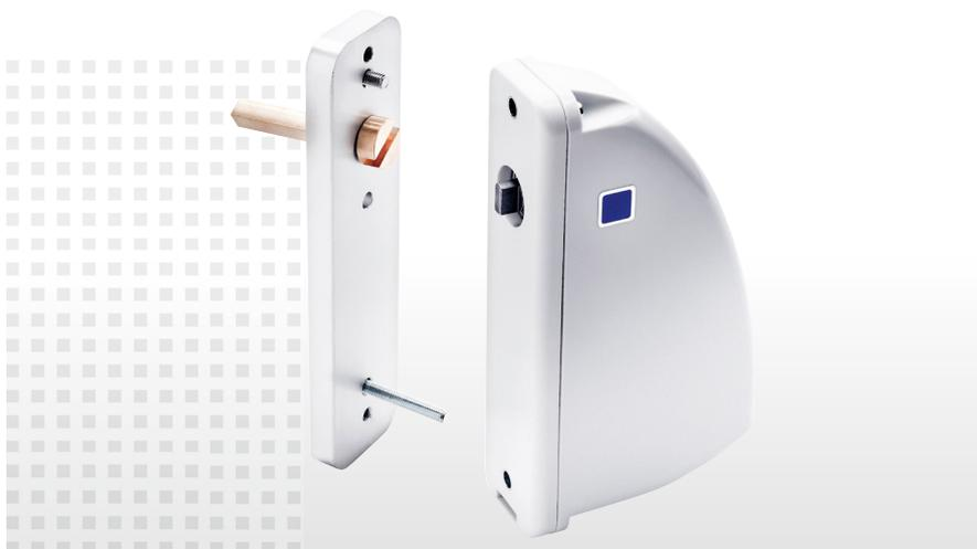
Электроприводы OFV от компании AUMÜLLER монтируются на створке вместо оконной ручки. Они двигают всю круговую обвязку, при этом крутящий момент составляет 10 Нм. Эти оконные приводы-замки используются для надежной блокировки и разблокировки всех видов окон, в частности поворотных и откидных, в комбинации с разными видами приводов.
