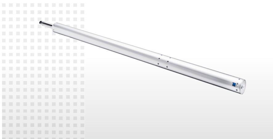
Штоковые приводы PLS от компании AUMÜLLER с усилием 1500–5000 N (в зависимости от серии) отлично подходят для надежного открытия и закрытия тяжелых окон на крышах. Компактный цилиндрический корпус привода, представляющий собой алюминиевую трубу диаметром 50 мм, прекрасно интегрируется в конструкцию крыш.
