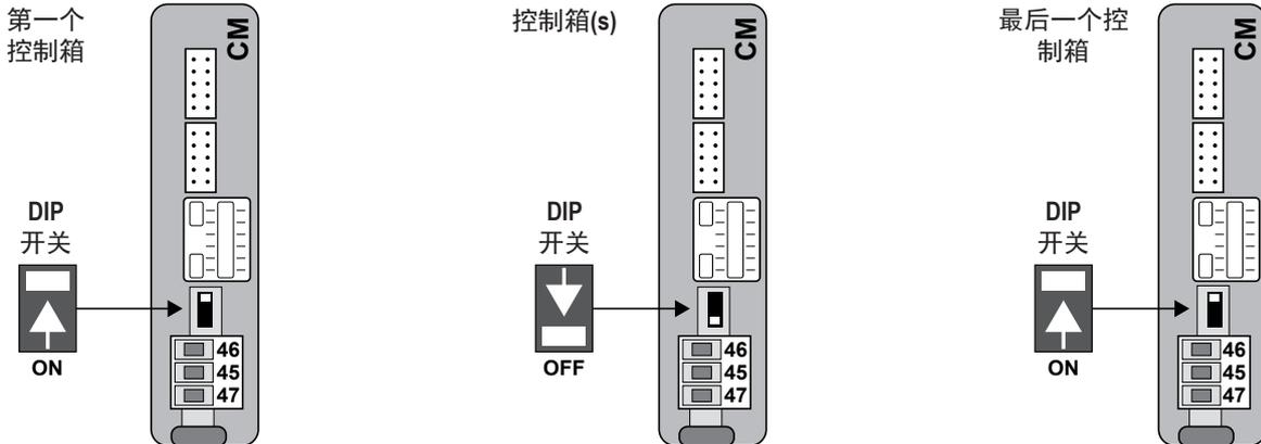
接线图: CAN总线系统
