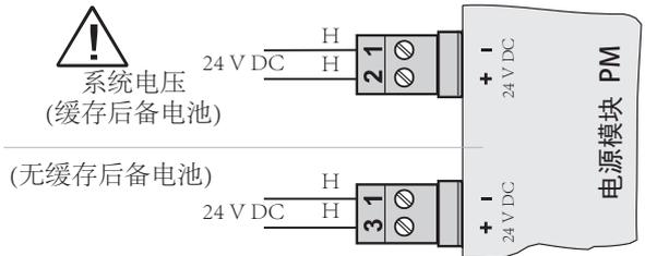
使用缓存后备电池供电, 减少桥接时间, 使用时后备电池容量需增大。
