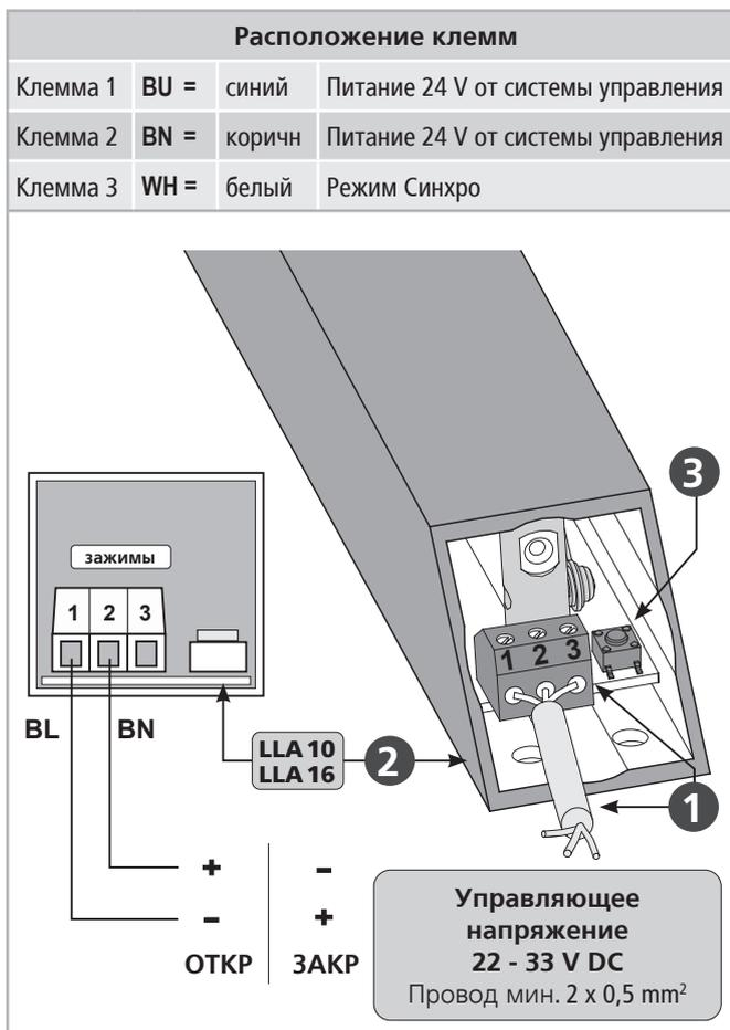
Кнопка ❸ в **ламельного привода LLA 10 / LLA 16 ❷** служит для изменения направления движения и расположен в **ламельного привода** со стороны троса.
