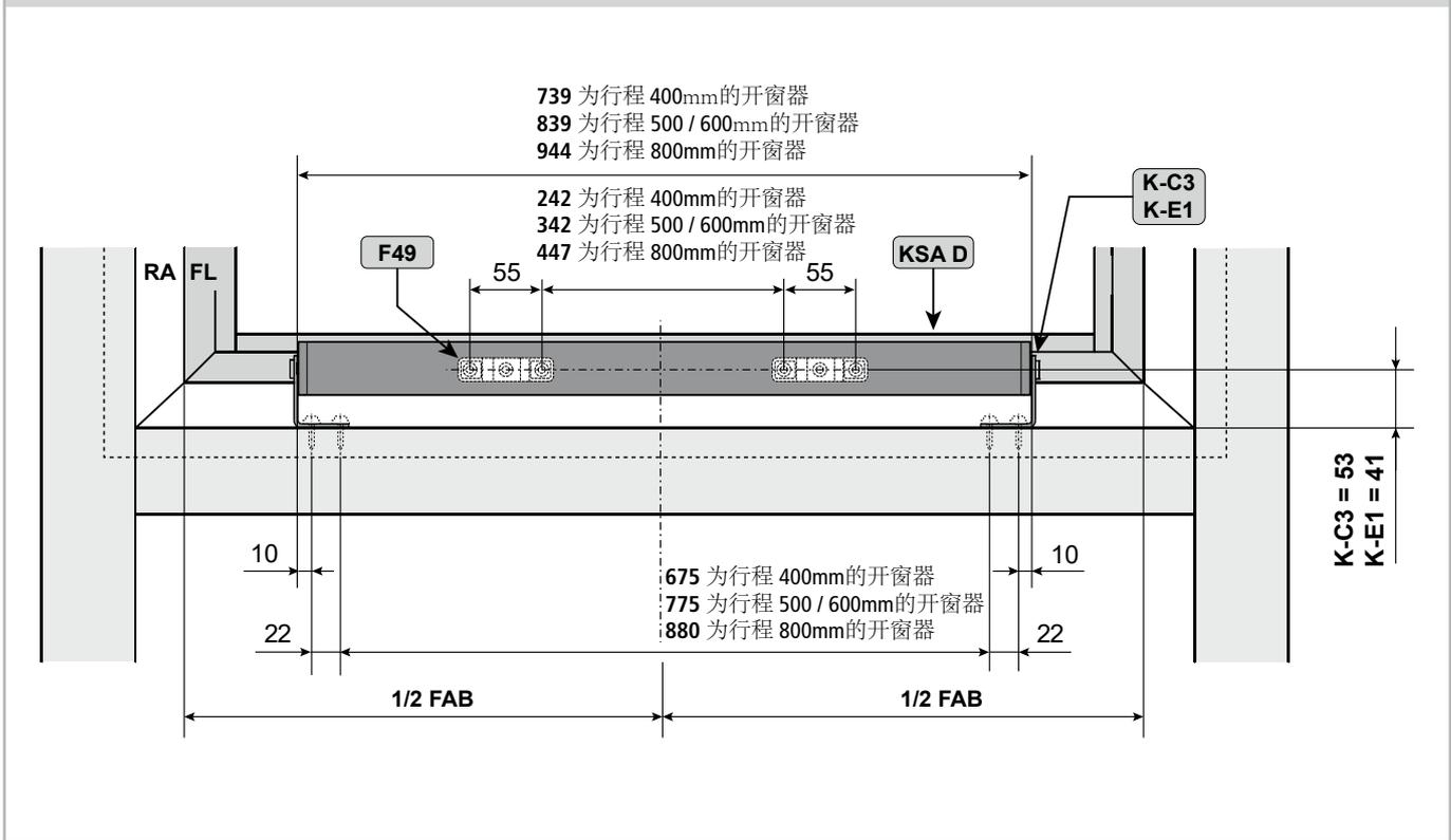
窗框支架 K-B1 和窗扇支架 F49在型材AWS 75.SI上的安装孔位置 (旭格)
