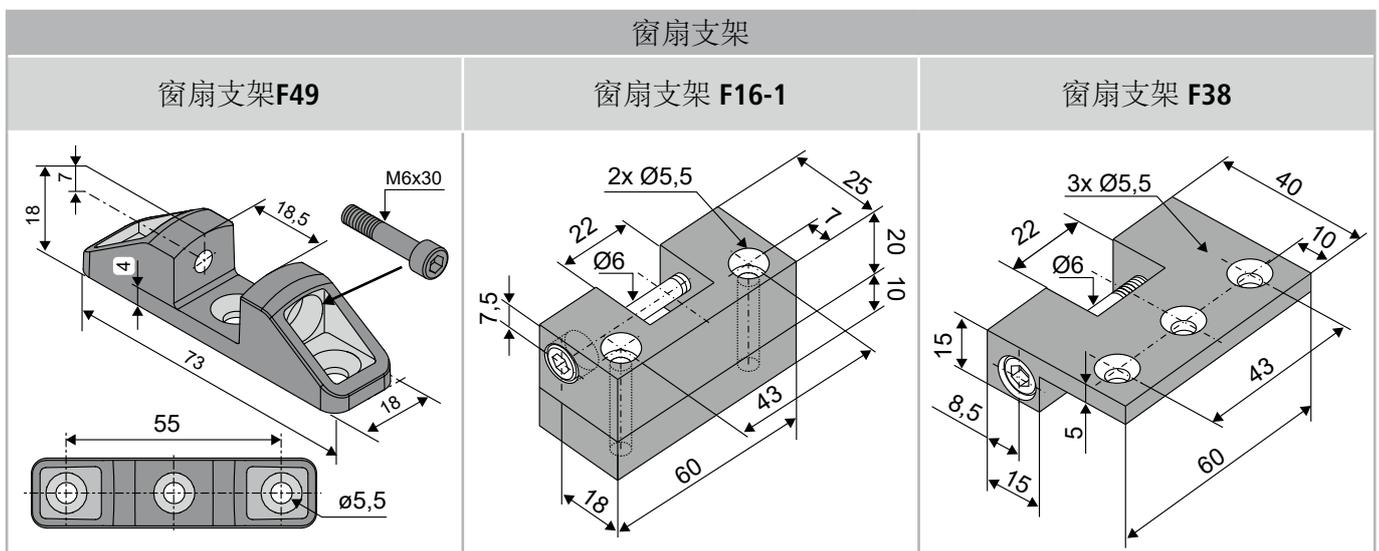
安装步骤 4: 窗扇支架和窗框支架的安装孔位置
