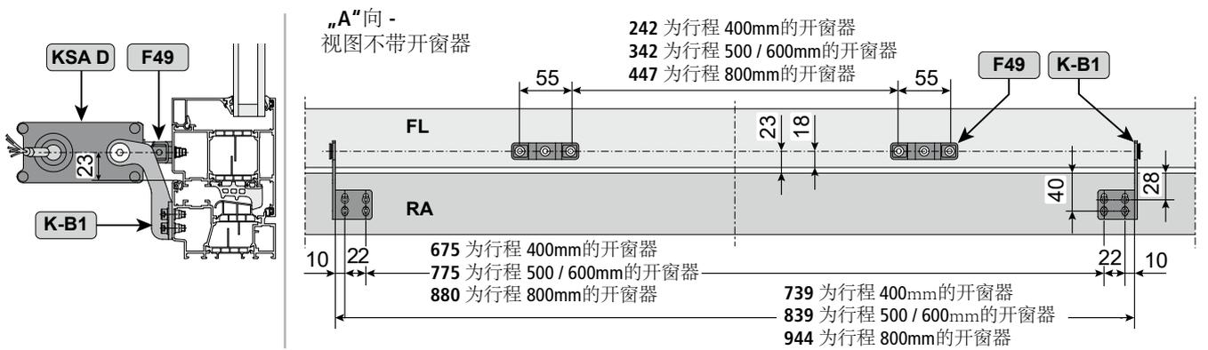
窗框支架K-B1 和窗扇支架 F38 在型材Wing 105D上的安装孔位置 (Raico)
